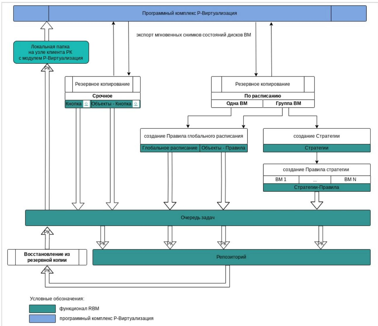
Рисунок 1. Структурная схема резервного копирования и восстановления виртуальных машин ПК Р-Виртуализация из ПК
