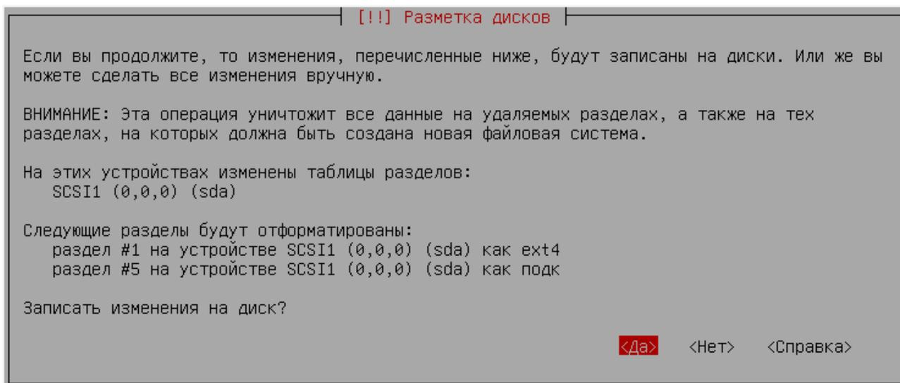
Рисунок 17. Согласие с внесением изменений на диск
