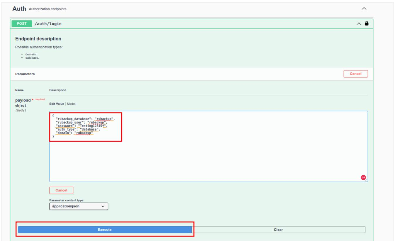
Рисунок 3. Заполнение payload авторизационными данными
