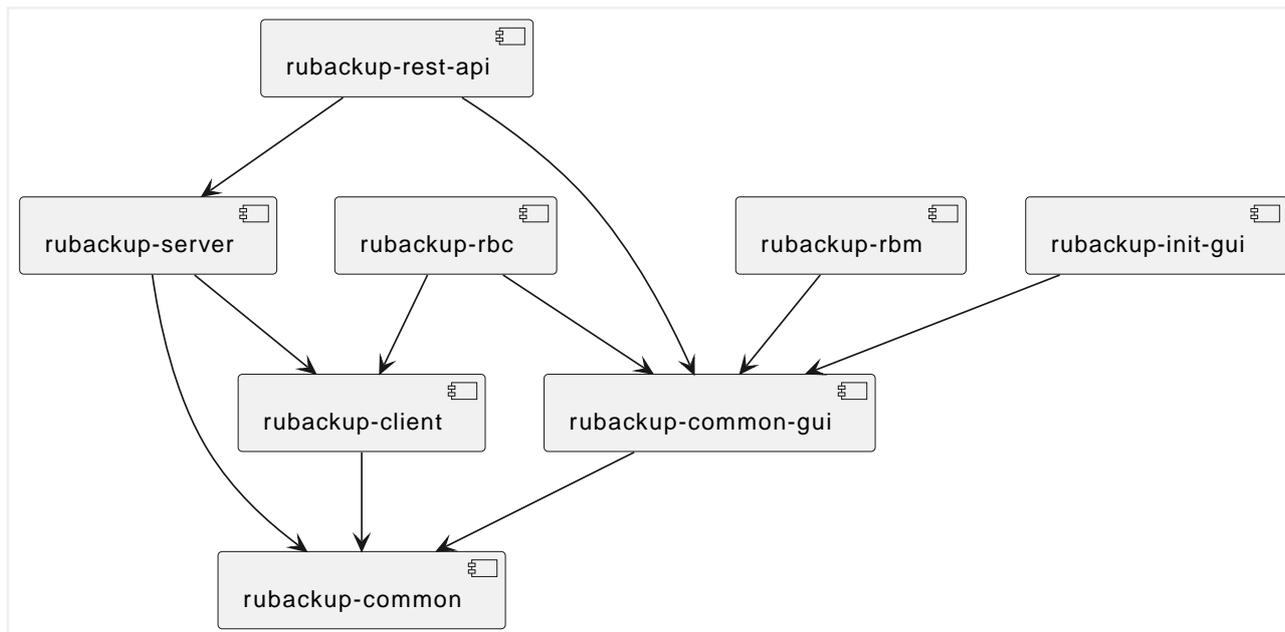
Рисунок 1. Зависимости пакетов RuBackup
