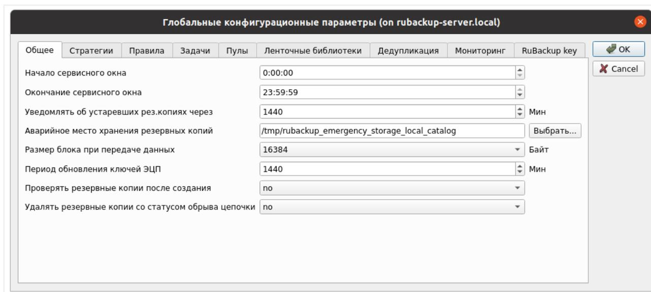
Рисунок 17. Общие параметры в настройках глобальной конфигурации RuBackup
