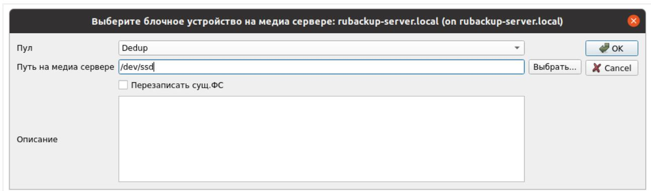
Рисунок 14. Добавление блочного устройства в пул хранения данных
